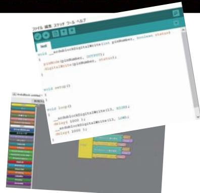
初心者向け 人気のマイコンボード「Arduino (アルドゥイーノ)」を使って、LED点滅灯のプログラムに挑戦します。
